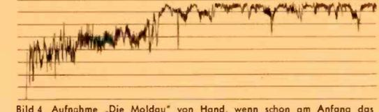
Bild 4 Aufnahme „Die Moldau“ von Hand, wenn schon am Anfang das Magische Auge ausschlägt. Bei Beginn der Fortstellen wird das Band übersteuert, die Wiedergabe klingt verzerrt. Diesen Fehler verhindert von vornherein die Regelschaltung des TK 19 automatic.
