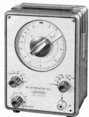
Bild 13 GRUNDIG RC-Generator TG 11. Eine ausführliche Beschreibung dieses Gerätes bringen wir im nächsten Heft der „Technischen Informationen“.
